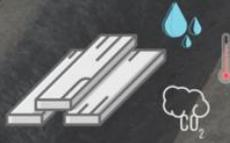
Processo em que as placas de fibrocimento foram expostas a uma determinada temperatura, umidade e níveis de dióxido de carbono (CO<sub>2</sub>), sendo condições adequadas para que o gás penetrasse nas placas, carbonatando o material e reduzindo a alcalinidade do sistema. Essa tecnologia permite uma melhora na durabilidade das fibras e nas propriedades físicas e mecânicas do fibrocimento.
